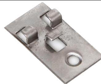
Le clip de fixation JUSTapposé® compatible avec toutes nos gammes de lames de terrasse est conçu pour être très simple d'utilisation. Résistant grâce à sa conception et sa matière en inox, il permet une fixation parfaite des lames. Se fixe avec une vis de dimensions 3,5 x 20 tête fraisée en inox.
