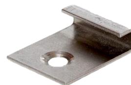
Le clip de départ JUSTapposé® compatible avec toutes nos gammes de lames de terrasse a été conçu pour débiter et faciliter la pose des lames. Sa matière en inox assure la longévité ainsi que la résistance du clip. Se fixe avec une vis de dimensions 3,5 x 20 tête fraisée en inox
